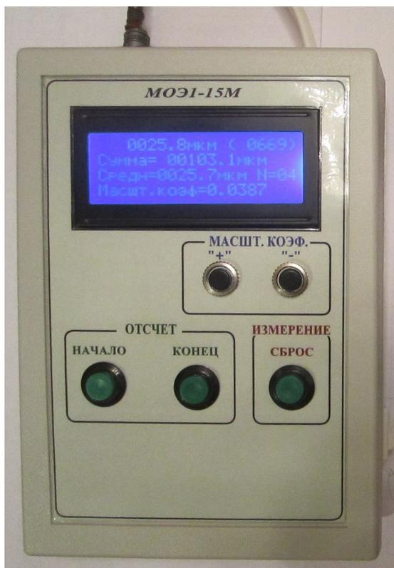
Окуляр-микрометр электронный «МОЭ1-15М» предназначен для измерения размеров элементов топологии и дефектов на фотошаблонах и полупроводниковых пластинах при совместной работе с оптическими микроскопами.
